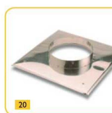
В устье дымовой трубы установить покровную плиту с манжетой (4) (Рисунок 20) и закрепить. Верхний элемент трубы (в устье) обрезать на расстоянии примерно 12 см от верхнего канта покровной плиты с манжетой (4). Установить трубу в устье строго по центру, используя винты с резьбой (Рисунок 21).
