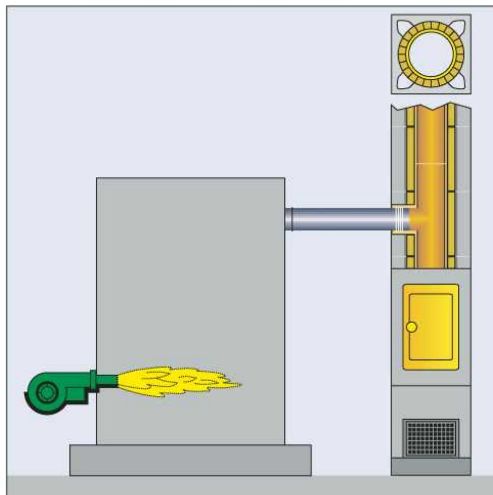
Сжигание жидкого топлива в котлах этого типа происходит при разрежении в топке котла. Аэродинамическое сопротивление котла и соединительных элементов со стороны дымовых газов преодолевается за счёт тяги, создаваемой дымовой трубой.
