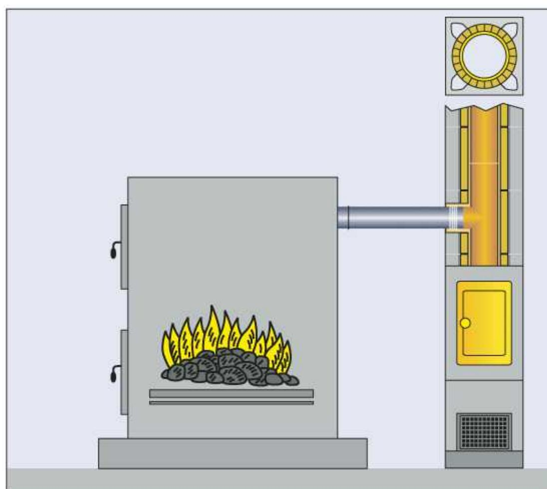
Твёрдое топливо - кокс, уголь или дрова - сжигается в котлах такого типа при разрежении в топке котла. Аэродинамическое сопротивление котла и соединительных элементов со стороны дымовых газов преодолевается за счёт тяги, создаваемой дымовой трубой.
