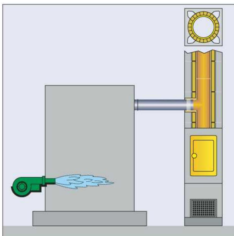
Сжигание природного газа в котлах этого типа происходит при разрежении в топке котла. Аэродинамическое сопротивление котла и соединительных элементов преодолевается за счёт тяги, создаваемой дымовой трубой.
