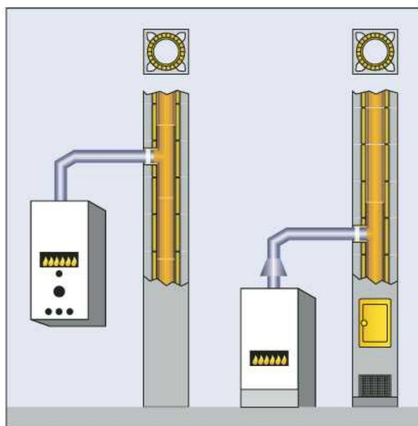
При использовании этого типа котлов между котлом и дымовой трубой устанавливается стабилизатор потока, основным назначением которого является предотвращение негативного влияния на процесс сжигания газа возможных колебаний тяги в дымовой трубе под влиянием различных погодных факторов. Аэродинамическое сопротивление стабилизатора потока и соединительных элементов преодолевается за счёт тяги, создаваемой дымовой трубой.
