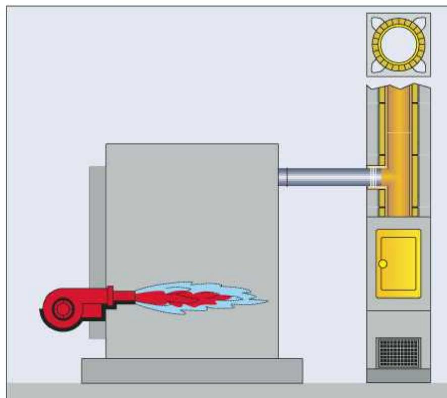
В котлах этого типа сжигание газа в топке котла происходит при избыточном давлении в камере сгорания. Движение дымовых газов через теплообменник осуществляется благодаря нагнетанию в топке. Аэродинамическое сопротивление соединительных элементов преодолевается за счёт тяги, создаваемой дымовой трубой.
