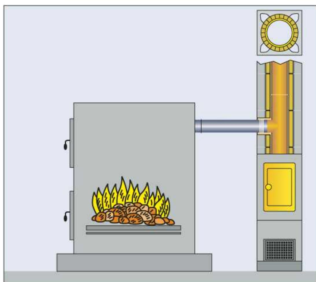
В этом типе котлов сжигание древесных пеллет происходит при разрежении в топке котла. Аэродинамическое сопротивление котла и соединительных элементов со стороны дымовых газов преодолевается за счёт тяги, создаваемой дымовой трубой.
