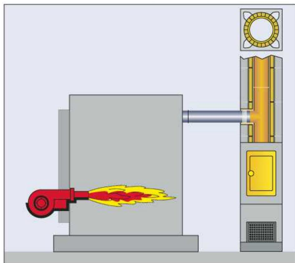
Сжигание жидкого топлива в котлах этого типа происходит при избыточном давлении в камере сгорания. Движение дымовых газов через теплообменник осуществляется благодаря нагнетанию в топке. Аэродинамическое сопротивление соединительных элементов преодолевается за счёт тяги, создаваемой дымовой трубой.
